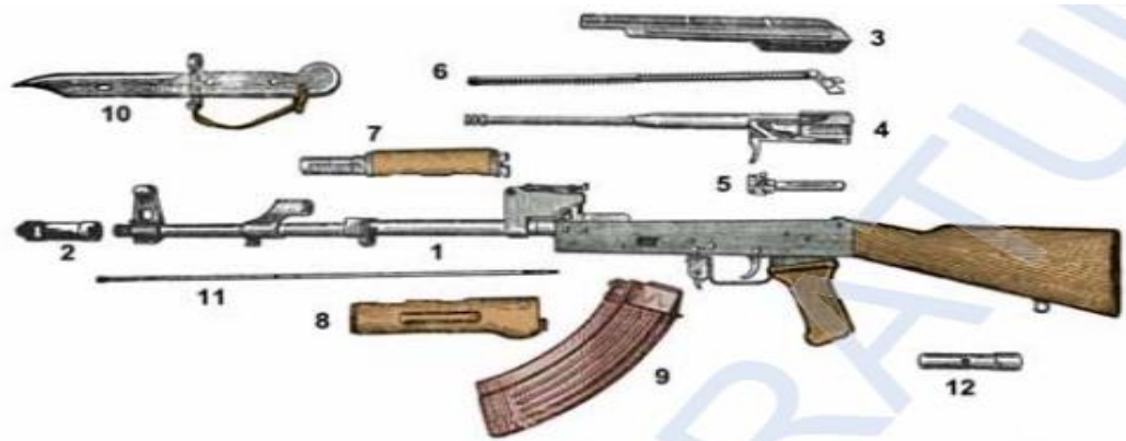
Ավտոմատի հիմնական մասերն ու մեխանիզմները. 1 - փողը՝ փողափուփով, նշանառության հարմարանքով, զարկանաձգանային մեխանիզմով և կոթով, 2 - փողաբերանի արգելակ, 3 - փողափուփի կափարիչ, 4 - փակադակի շրջանակ՝ գազամխոցով, 5 - փակադակ, 6 - հետադարձ մեխանիզմ, 7 - գազամխողովակ՝ փողի պահպանակով, 8 - փողակալ, 9 - պահեստարան, 10 - սվին-դանակ, 11 - շամփուր, 12 - պի-տույքների պահարան:
