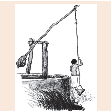
Շաղուֆը նման էր ջրհորից ջուր հանող կրունկի, կարճ ծայրին կապվում էր մեծ ծանրություն, իսկ երկար ծայրից կախված էր դույլը: Նեղոսից դույլով ջուր էին բարձրացնում և ջուրը դադարկում բարձրադիր դաշտերը ջրող սուվի մեջ:
