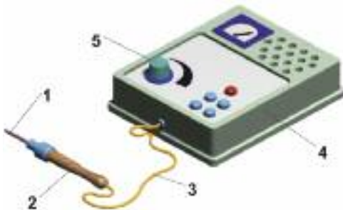
1 - ասեղ, 2 - բռնակ, 3 - էլեկտրալար, 4 - տրանսֆորմատոր, 5 - կարգավորիչ:
